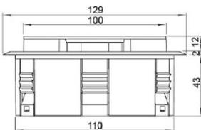
**KBK Outlet Z30** Teleskopauslass (kein Anschluss KBK)
