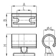
Clip zur Befestigung der Kabelführungssysteme KBKCUB, KBKCMX, KBKPRO, KBKCL, KBKFLII an Profilen und Kanten. Profildurchmesser bis zu 12 mm.
